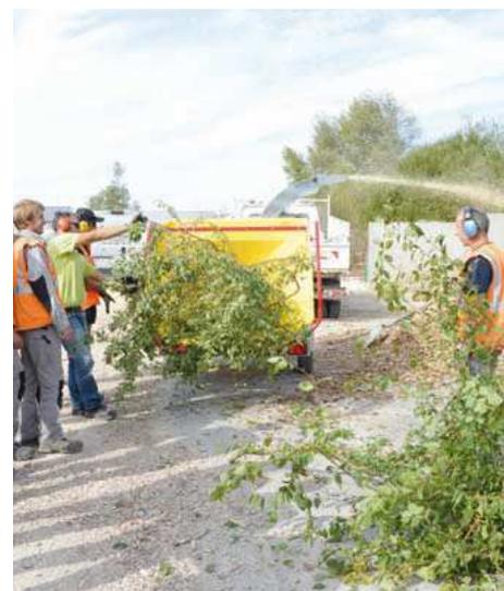
Désormais, des branches pouvant aller jusqu'à 13 cm de diamètre peuvent être broyées. Les broyats sont ensuite utilisés pour le paillage des massifs. Cette technique permet des économies d'eau et limite la pousse d'herbes indésirables et donc l'utilisation de désherbants chimiques. Par ailleurs, la décomposition du paillage contribue à l'enrichissement du sol en restituant à la terre les éléments fertilisants et les oligo-éléments indispensables au bon développement des plantes.
